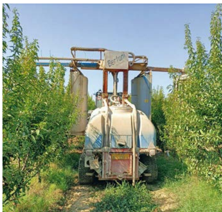
Foto 3 Gli atomizzatori a recupero trovano favorevoli applicazioni soprattutto in filari stretti come quelli degli impianti intensivi di mandorli
